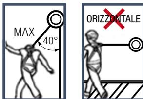
DISPOSITIVO DOTATO DI FRENATURA AUTOMATICA AD INERZIA.
