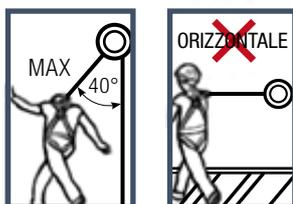
DISPOSITIVO DOTATO DI FRENATURA AUTOMATICA AD INERZIA.
