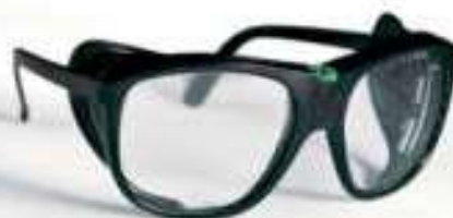
000187 OCCHIALE 317N-C EN 166 Occhiale a stanghetta con ripari laterali, lenti bombate in policarbonato incolore Imballo: 20 pz.
